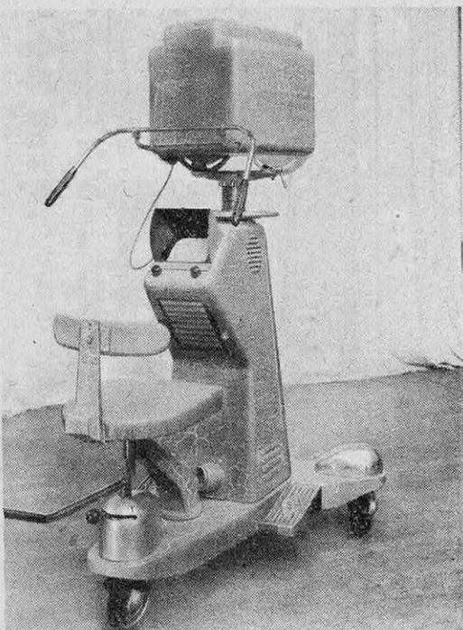
FIG. 4. — UNE CAMERA ÉLECTRONIQUE MOBILE ÉQUIPÉE AVEC UN TUBE ISOSCOPE (BARTHÉLEMY)
