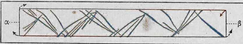
FIG. 1. — LE FENDILLEMENT D'UNE GLACE SOUS L'EFFET D'UN EFFORT DE TORSION (EXPÉRIENCE DE DAUBRÉE)
