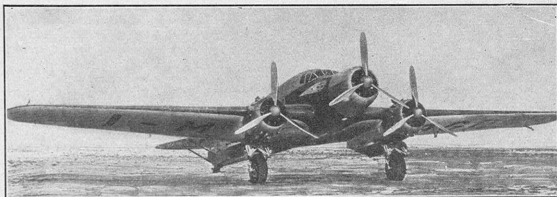
FIG. 4. — AVION « SAVOIA-MARCHETTI », TYPE « S.-79 », A TROIS MOTEURS PIAGGIO-STELLA DE 600 CH, AVEC HÉLICES TRIPALES A PAS VARIABLE EN VOL (ITALIE)
