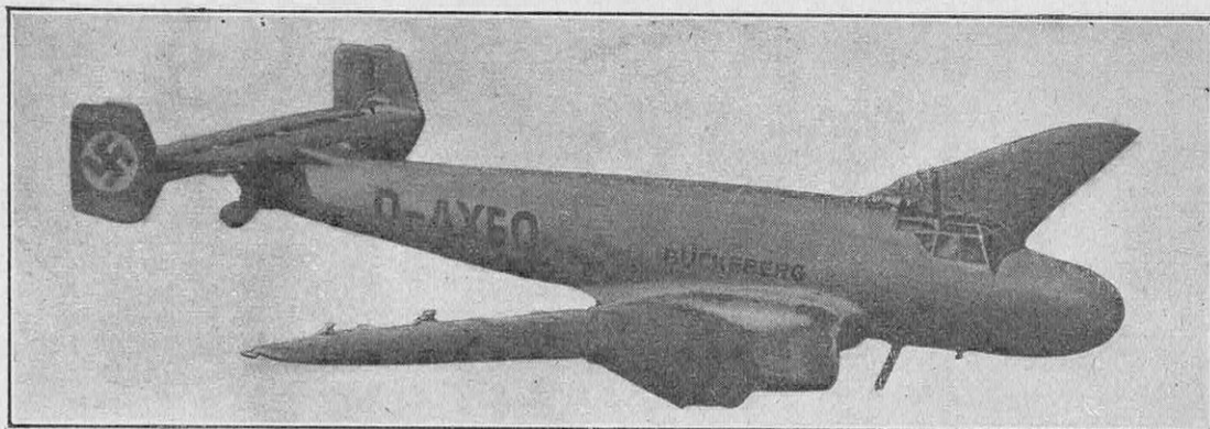
FIG. 5. — AVION « JUNKERS » (« JU-86 »), DE CONSTRUCTION ENTIEREMENT MÉTALLIQUE, ÉQUIPÉ DE DEUX MOTEURS A HUILE LOURDE JUMO-205 DE 600 CH CHACUN (ALLEMAGNE) Cet appareil, qui pèse à vide 5 630 kg, peut emporter une charge utile de 2 220 kg. Son rayon d'action atteint 2 250 km. Sa vitesse maximum est de 315 km/h et sa vitesse de croisière de 285 km/h.
