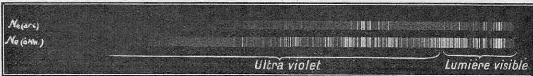
FIG. 6. — DEUX SPECTRES DU NÉON (EN HAUT, SPECTRE D'ARC ; EN BAS, SPECTRE D'ÉTINCELLES) On remarquera combien, surtout dans le spectre d'étincelles, la région de l'ultraviolet est étendue relativement au spectre visible. Le procédé André Claude transforme l'ultraviolet en lumière visible par le phénomène de fluorescence.
