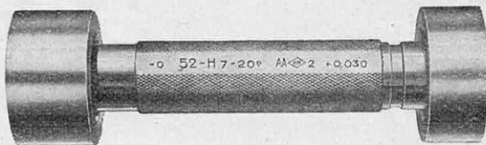
FIG. 3. — TAMPON DOUBLE POUR LA VÉRIFICATION DES ALÉSAGES NORMAUX
