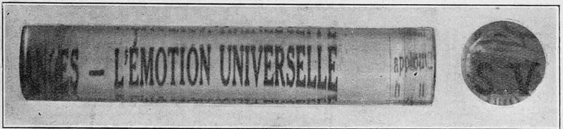
FIG. 2. — VOICI UN CYLINDRE EN « POLLOPAS », VERRE ORGANIQUE A BASE D'URÉE On voit nettement, quand on le regarde soit latéralement, soit en bout, les caractères placés derrière lui, ce qui prouve que sa transparence est parfaite, comme celle du « Rhodoïd ».
