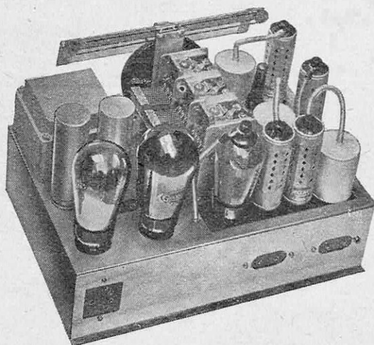
VUE INTÉRIEURE DU POSTE R. S. 8
