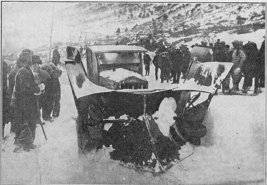
FIG. 5. — LE PLUS PUISSANT CHASSE-NEIGE AMÉRICAIN A TURBINES LATÉRALES QUI A RÉUSSI A SE-FRAYER UN PASSAGE SUR UNE ROUTE RECOUVERTE DE 3 MÈTRES DE NEIGE
