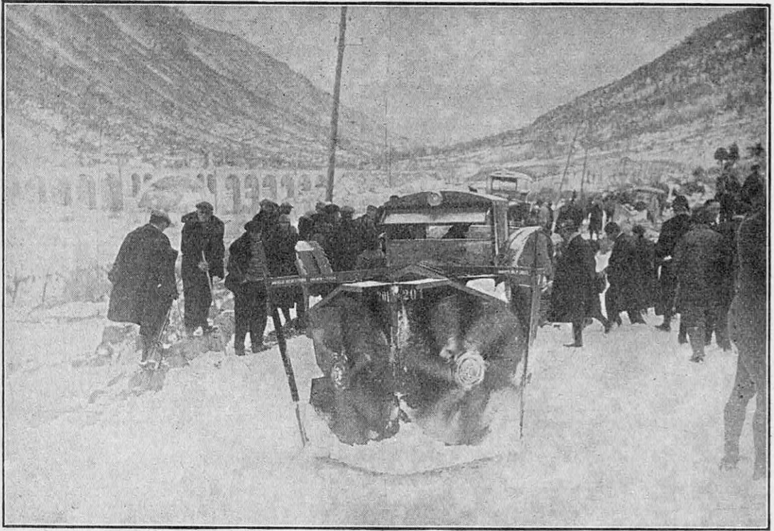
FIG. 4. — CHASSE-NEIGE AMÉRICAIN A TURBINES ATTAQUANT DIRECTEMENT LA NEIGE
