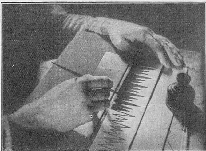
FIG. 3. — VOICI UN OPÉRATEUR AU TRAVAIL, EN TRAIN DE PRÉPARER UNE BANDE SONORE « SYNTHÉTIQUE »
