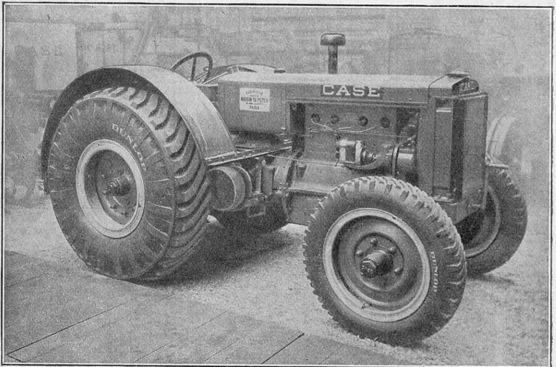
FIG. 4. — VOICI UN TRACTEUR MONTÉ SUR GROS PNEUS A TRÈS BASSE PRESSION
