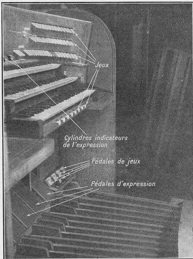
FIG. 6. — LA CONSOLE DE L'ORGUE RADIOPHONIQUE VUE DU COTÉ DES CLAVIERS, C'EST-A-DIRE DE L'ORGANISTE En bas, le pédalier des basses. Au-dessus, les pédales d'expression. A côté de celles-ci, quelques pédales de jeux. Au-dessous du premier clavier, quelques tirettes de jeux. Puis les trois claviers. Au-dessus d'eux, les quatre cylindres bicolores indiquant le « degré » d'expression (par blanc ou noir). Enfin, tout en haut, les targelettes qui déclanchent les divers jeux de l'orgue.
