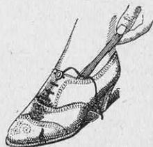
CI-DESSUS : ON PASSE LE LACET DANS L'APPAREIL ; EN HAUT, A DROITE : ON SERRE LE LACET D'UNE SEULE MAIN ; CI-CONTRE : ON CACHE LE LACET DANS LA CHAUSSURE
