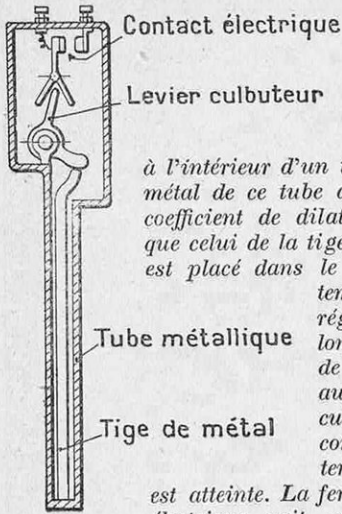
FIG. 6. — PRIN- CIPES DU THER- MOSTAT
