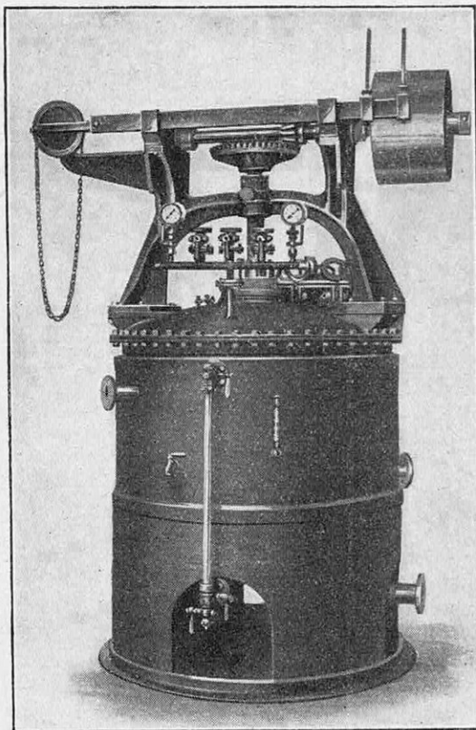
FIG. 4. — MALAXEUR POUR HOMOGÉNÉISER LA SOLUTION DE VISCOSE AVANT FILATURE
