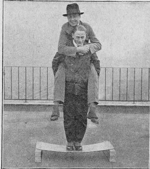
FIG. 12. — UNE GLACE DE PARE-BRISSE EN « SÉCURIT », POSÉE SUR DEUX TASSEAUX, SOUTIÈNE, SANS SE BRISER, LE POIDS DE DEUX HOMMES APPLIQUÉ EN SON MILIEU
