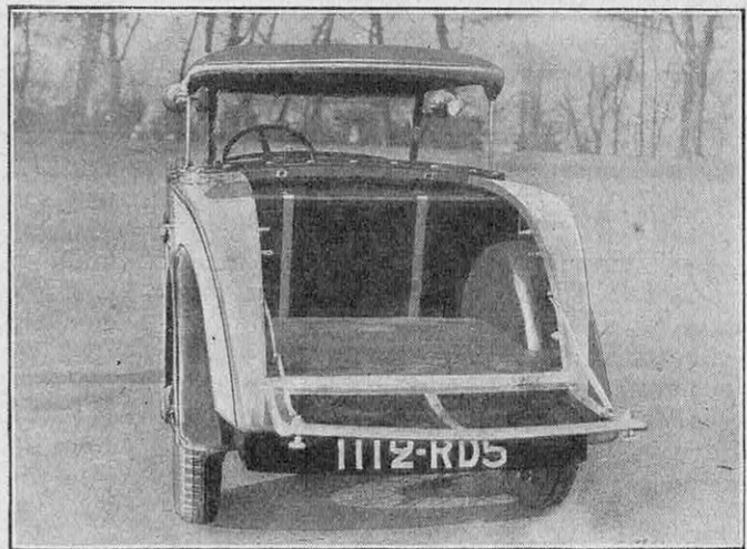
LA COUCHETTE REPLIÉE, LA CAISSE DU SPEEDER REDEVIENT LIBRE POUR RECEVOIR LES BAGAGES
