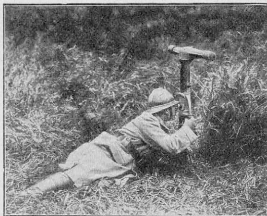
FIG. 9. — TÉLÉMÈTRE PÉRISCOPIQUE A COINCIDENCE DE 0 M. 50 DE BASE EN SERVICE SUR SON PIED
