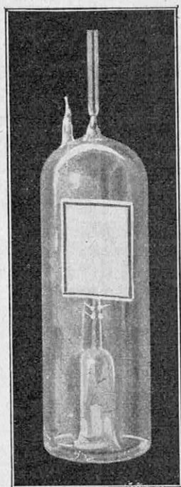
FIG. 3. — LA LAMPE RÉCEPTRICE AU NÉON DE LA BELL COMPANY Les grandes dimensions de la plaque qui forment la cathode permettent d'obtenir une intensité lumineuse plus grande et un éclaircissement très uniforme, ce qui correspond à une très grande pureté de la modulation du rayon balayeur.
