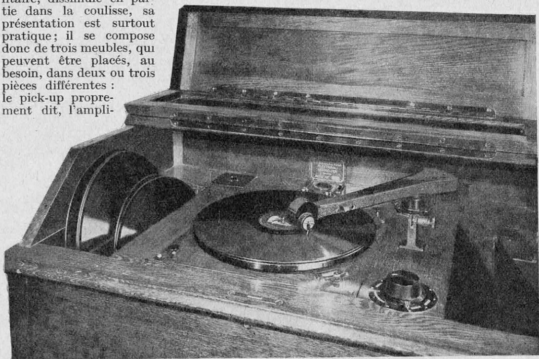
FIG. 1. — PARTIE SUPÉRIEURE DU PUPITRE SUPPORTANT LE DIAPHRAGME ÉLECTRIQUE « LA VOIX DE SON MAÎTRE »
