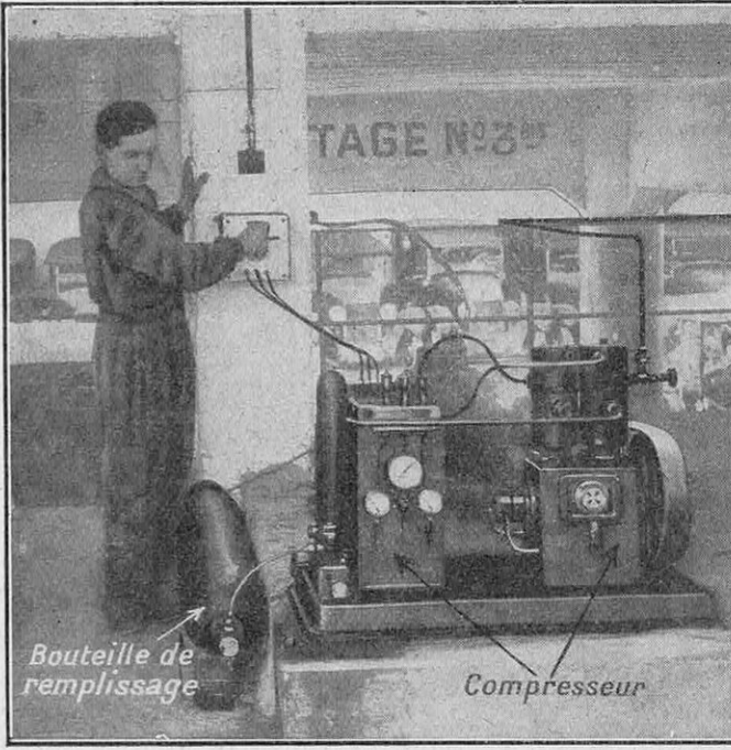
COMPRESSEUR « LUCHARD » POUR LA RECHARGE DES BOUTEILLES D'AIR DESTINÉES AU GONFLAGE DES PNEUMATIQUES, INSTALLÉ DANS UN GRAND GARAGE MODERNE (GARAGE DU PARC A NEUILLY)
