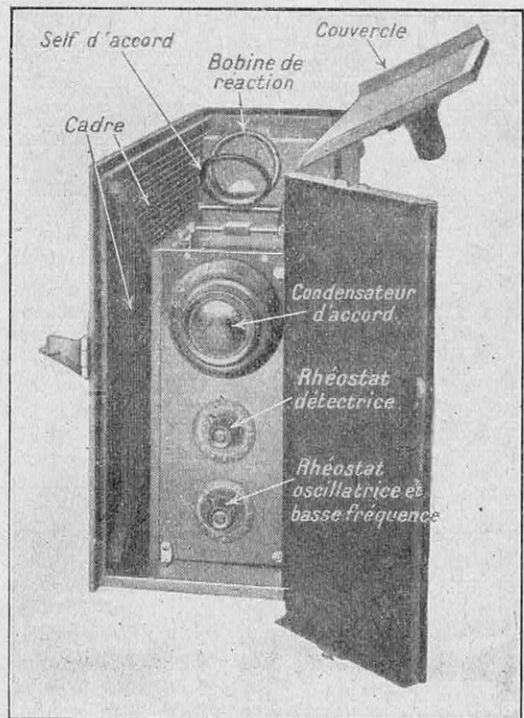
VUE INTÉRIEURE DU POSTE MALLETTTE
