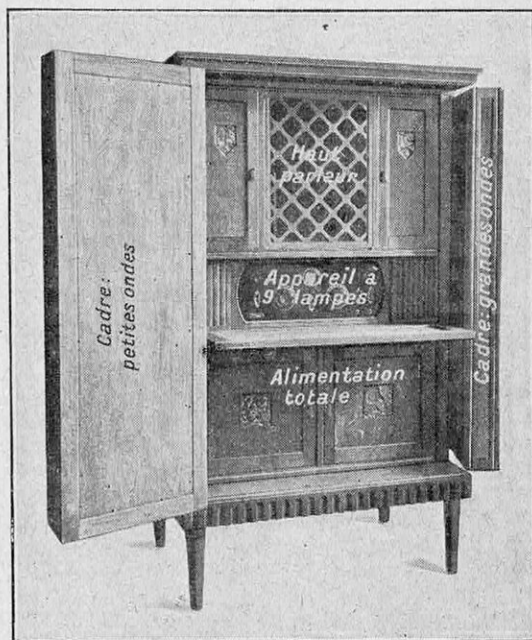
LE MEUBLE DU POSTE P. R. E. F. 9. TOUS LES ORGANES CONSTITUANT LE POSTE SONT ENFERMÉS DANS LE MEUBLE
