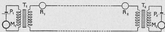
FIG. 2. — SCHEMA D'UNE TRANSMISSION TÉLÉPHONIQUE M 1 M 2 , microphones ; T 1 T 2 , transformateurs ; P 1 P 2 , piles ; R 1 R 2 , récepteurs.
