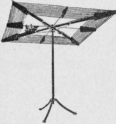
CADRE PARAPLUIE utilisé comme antenne intérieure
