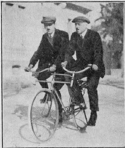
CETTE BICYCLETTE, SUR LAQUELLE DEUX PERSONNES PEUVENT PÉDALER CÔTE A CÔTE, SE TRANSFORME AISEMENT EN UN VÉLO ORDINAIRE
