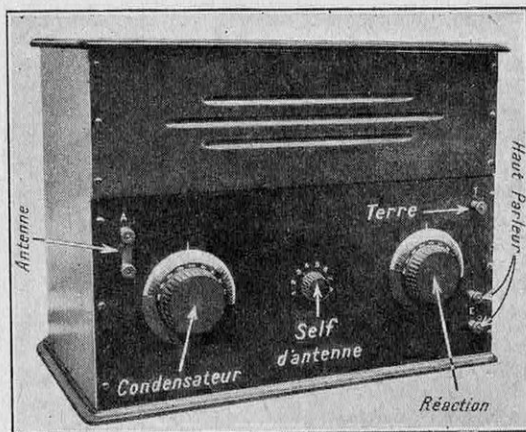
VUE EXTÉRIEURE DU POSTE « SECTORA » A ALIMENTATION DIRECTE
