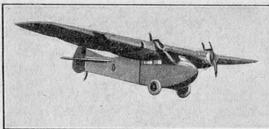
AVION FOCKE WULF « G.-L. 18 », DEUX MOTEURS JUNKERS 75 CH (ALL.), EN SERVICE EN U. R. S. S.
