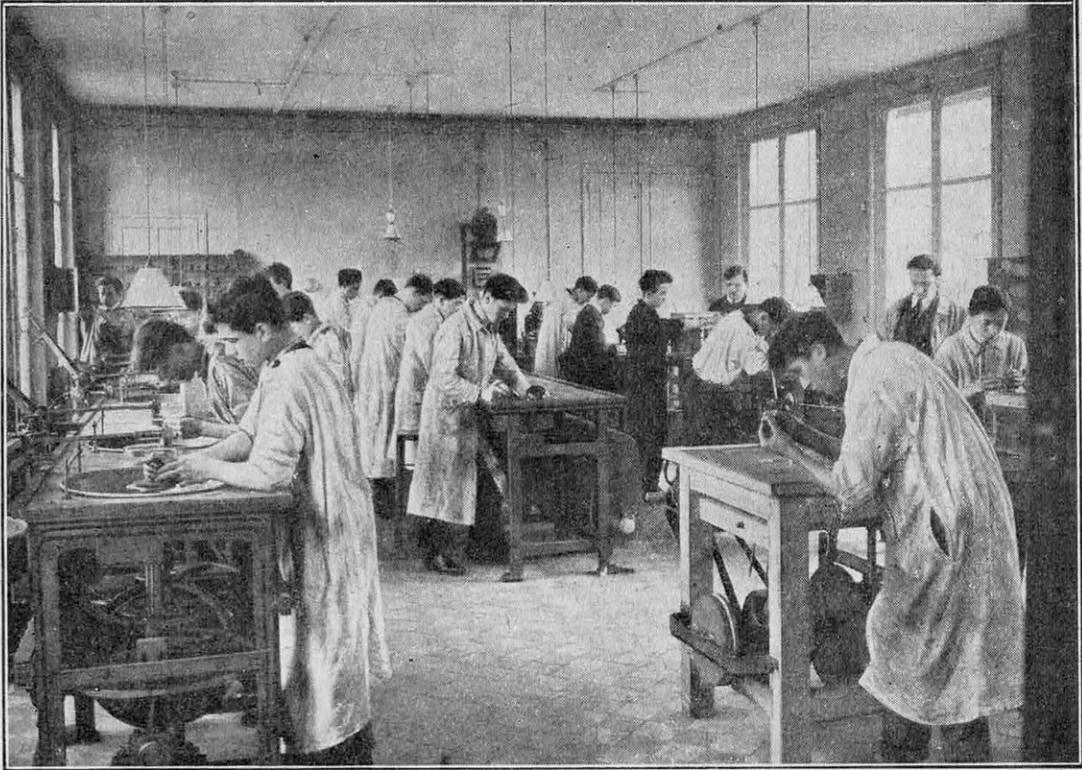
UN DES ATELIERS OU LES ÉLÈVES DE L'INSTITUT D'OPTIQUE APPRENNENT A TRAVAILLER LE VERRE DESTINÉ A LA FABRICATION DE LENTILLES, DE PRISMES, ETC., POUR LES INSTRUMENTS D'OPTIQUE
