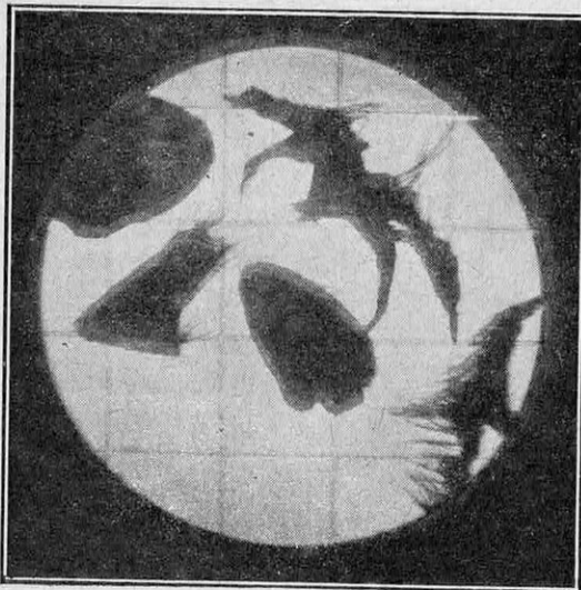
FIG. 3 ET 4. — VUES MICROPHOTOGRAPHIQUES DE DÉCHETS ENLEVÉS PAR L'ÉPOINTEUSE ET LA BROSSÉ, REPRÉSENTÉES SUR LA FIGURE CI-DESSUS
