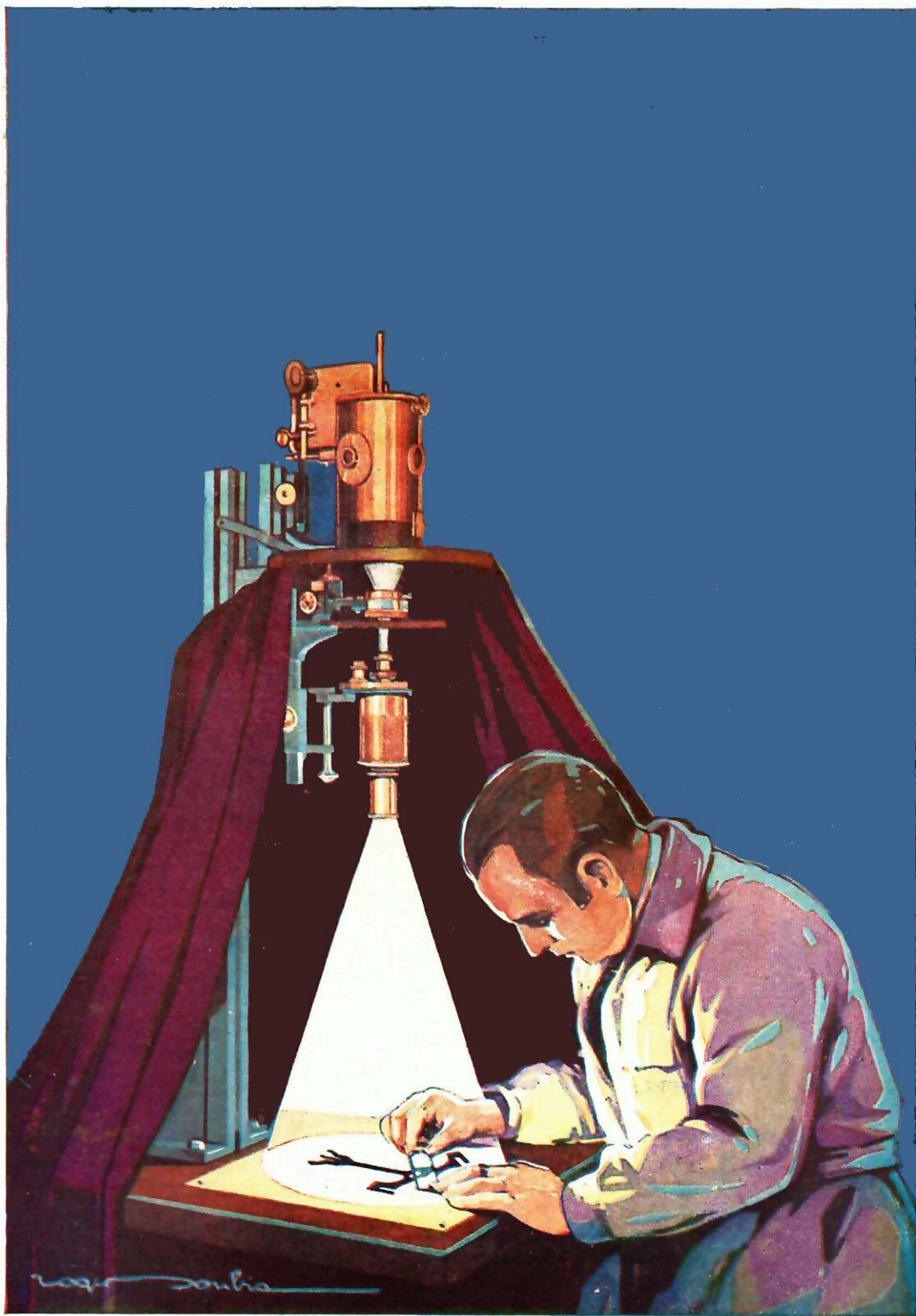
Au moyen du microscope à projection, l'opérateur vérifie la précision des pièces au millième de millimètre.
