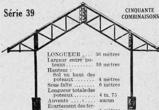
Toiture : fibro ondulé d'un côté, vitrage de l'autre côté.
