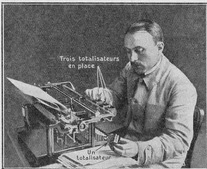
MACHINE « REMINGTON ». MISE EN PLACE D'UN TOTALISATEUR
