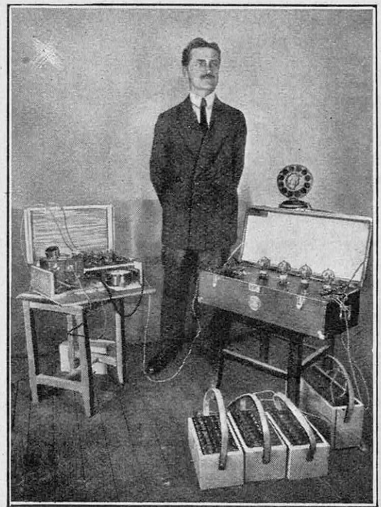
FIG. 8. — DISPOSITIF AMPLIFICATEUR UTILISÉ POUR LA TRANSMISSION DES DIVERS DISCOURS PRONONCÉS A GENÈVE
