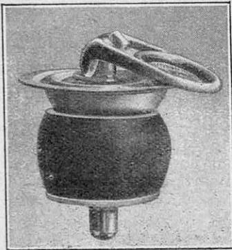
VUE DU BOUCHON, LE LEVIER ÉTANT RABATTU, MONTRANT L'ÉCRASEMENT DU CYLINDRE DE CAOUTCHOUC
