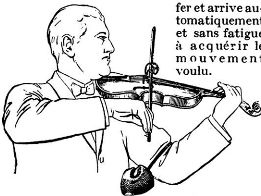
LE COUDE APPUYÉ SUR UN COUSSIN ÉLASTIQUE, L'ARCHET GUIDÉ PAR L'APPAREIL, LE VIOLONISTE DÉBUTANT PREND NATURELLEMENT LA POSITION CONVENABLE
