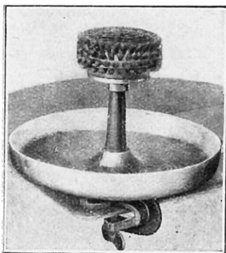
FIG. 1. - EN COIFFANT CETTE BROSSSE MÉTALLIQUE ROTATIVE DES RÉCIPIENTS A NETTOYER, TOUTES LES MATIÈRES GRATTÉES RETOMBENT DANS LA CUVETTE INFÉRIEURE
