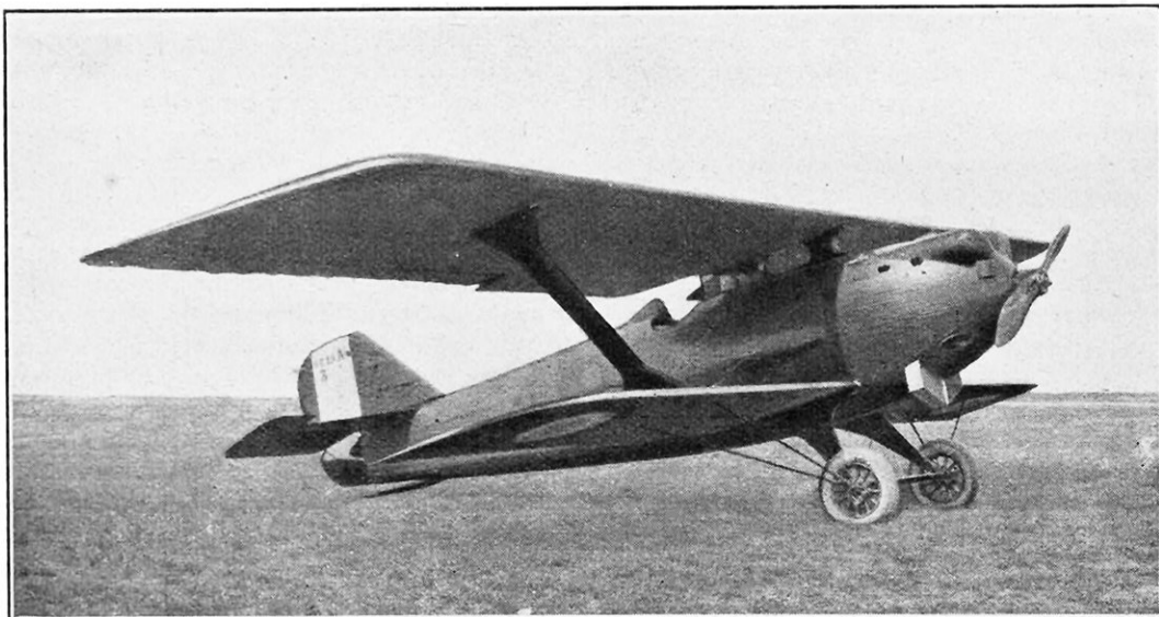
FIG. 7. — AVION BRÉGUET-XIX, DE RECONNAISSANCE, DE BOMBARDEMENT ET DE TRANSPORT, AVEC MOTEUR LORRAINE-DIETRICH DE 400 CV, MODÈLE UTILISÉ PAR PELLETIER DOISY POUR SON RAID PARIS-SHANGHAI
