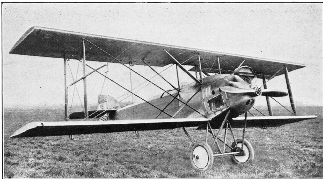
FIG. 6. — AVION-ÉCOLE HANRIOT MUNI D'UN MOTEUR HISPANO-SUIZA DE 180 CV, A HUIT CYLINDRES EN V
