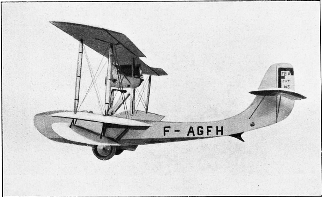
FIG. 9. — HYDRAVION SCHRECK A MOTEUR HISPANO, DE 350-400 CV
