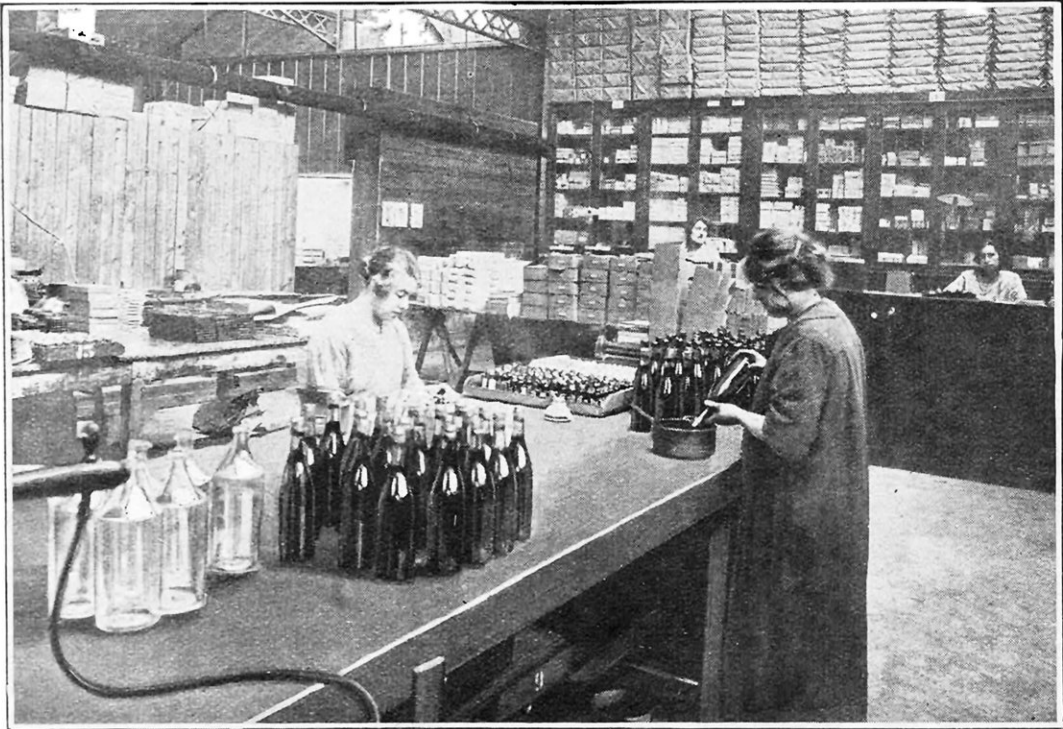
CACHETAGE A LA CIRE DES BOUTEILLES REMPLIES D'ENCRE
