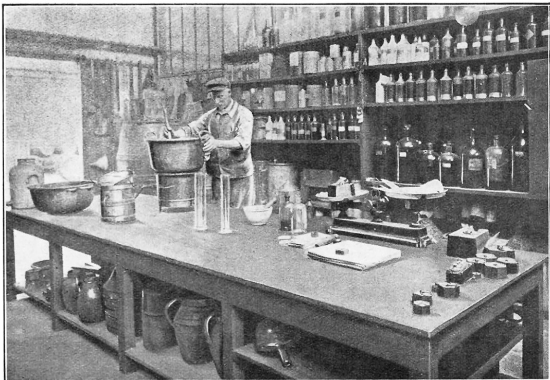
FABRICATION, DANS UNE BASSINE SPÉCIALE, DES ENCRES DE COULEUR : VERTES, ROUGES, BLEUES, ET DES ENCRES D'OR ET D'ARGENT
