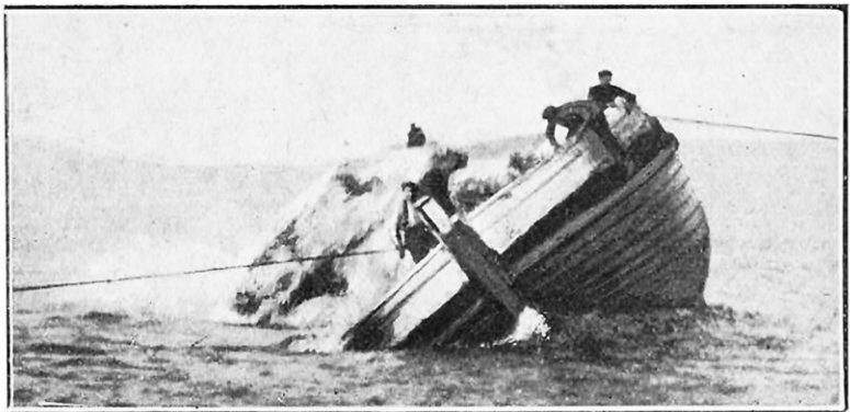
FIG. 6. — LE BATEAU PONTÉ VERSANT SON CHARGEMENT A LA MER PAR LE PROCÉDÉ DIT « A LA BANDE »
