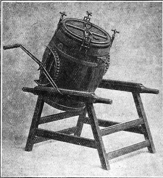
FIG. 2. — MÉCANIQUE DE BALANCEMENT DE LA CUVE DE LA MACHINE A LAVER « SAMO »
