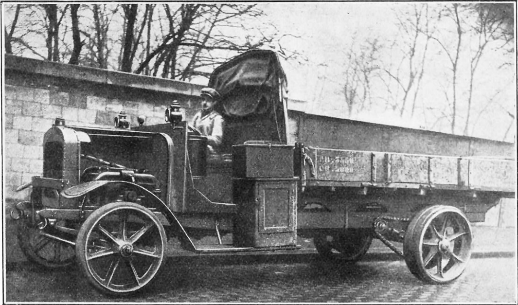
CAMION AUTOMOBILE POURVU D'UN MOTEUR A NAPHTALINE
