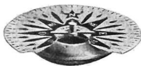
FIG. 11. — LA ROSE IMMERGÉE VUE DE FACE ET SON FLOTTEUR
