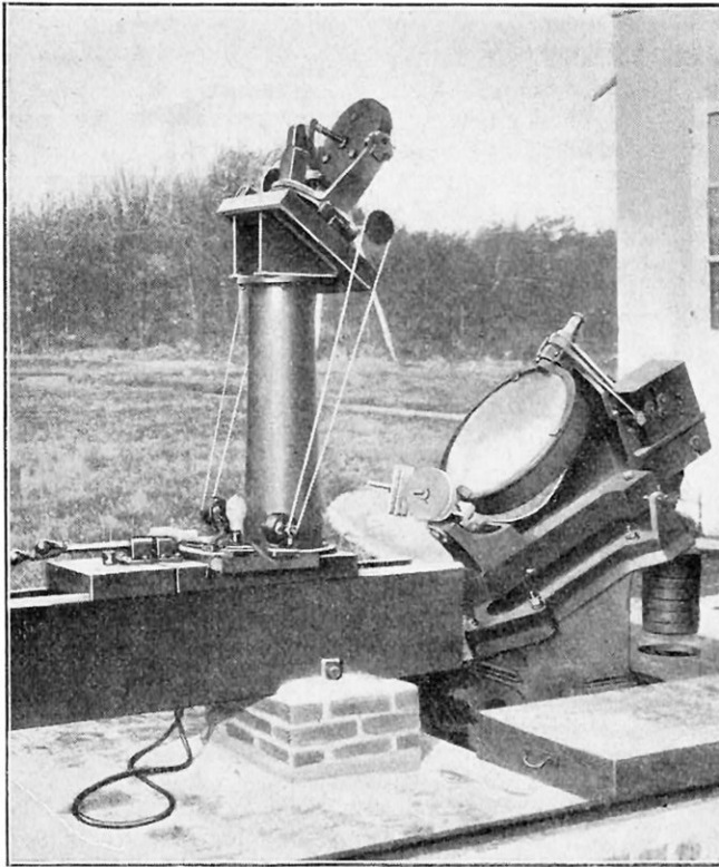
COELOSTAT A DEUX MIROIRS DE L'OBSERVATOIRE D'ASTRONOMIE PHYSIQUE DE MEUDON
