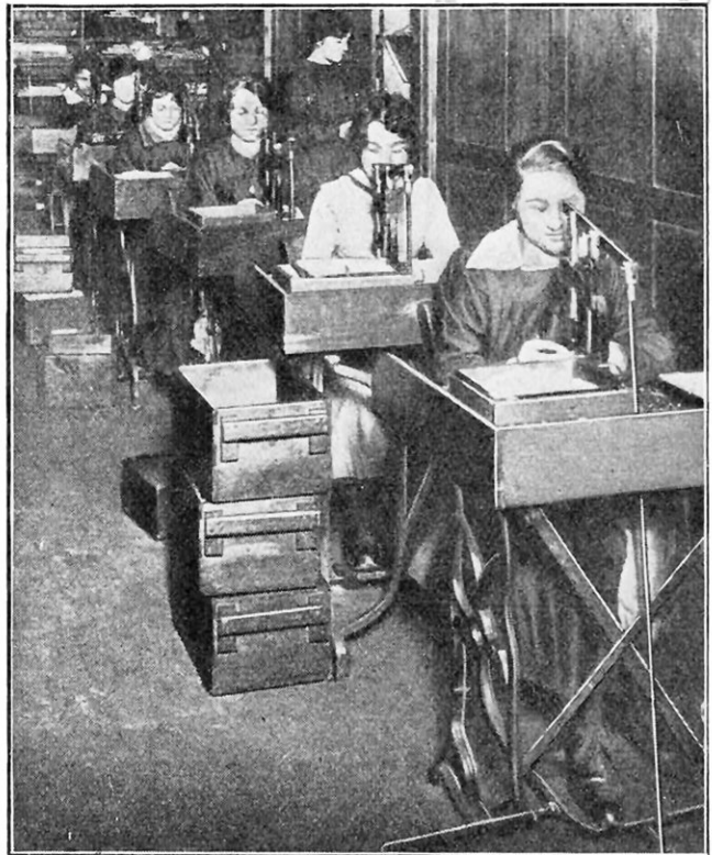
MISE EN PLACE, DANS LE FOND DU BOUCHON DU TUBE, D'UNE PETITE RONDELLE DE LIÈGE
