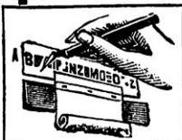
permet de tracer vite et bien des lettres et chiffres, comparables à des caractères imprimés, sur dessins, plans, dossiers, fiches, etc., etc...
