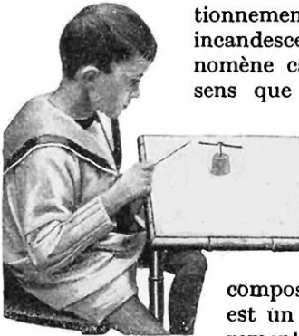
FIG. 1. — LE POLE SUD DE LA BOUSSOLE EST REPOUSSÉ PAR LE POLE SUD DE L'AIGUILLE
