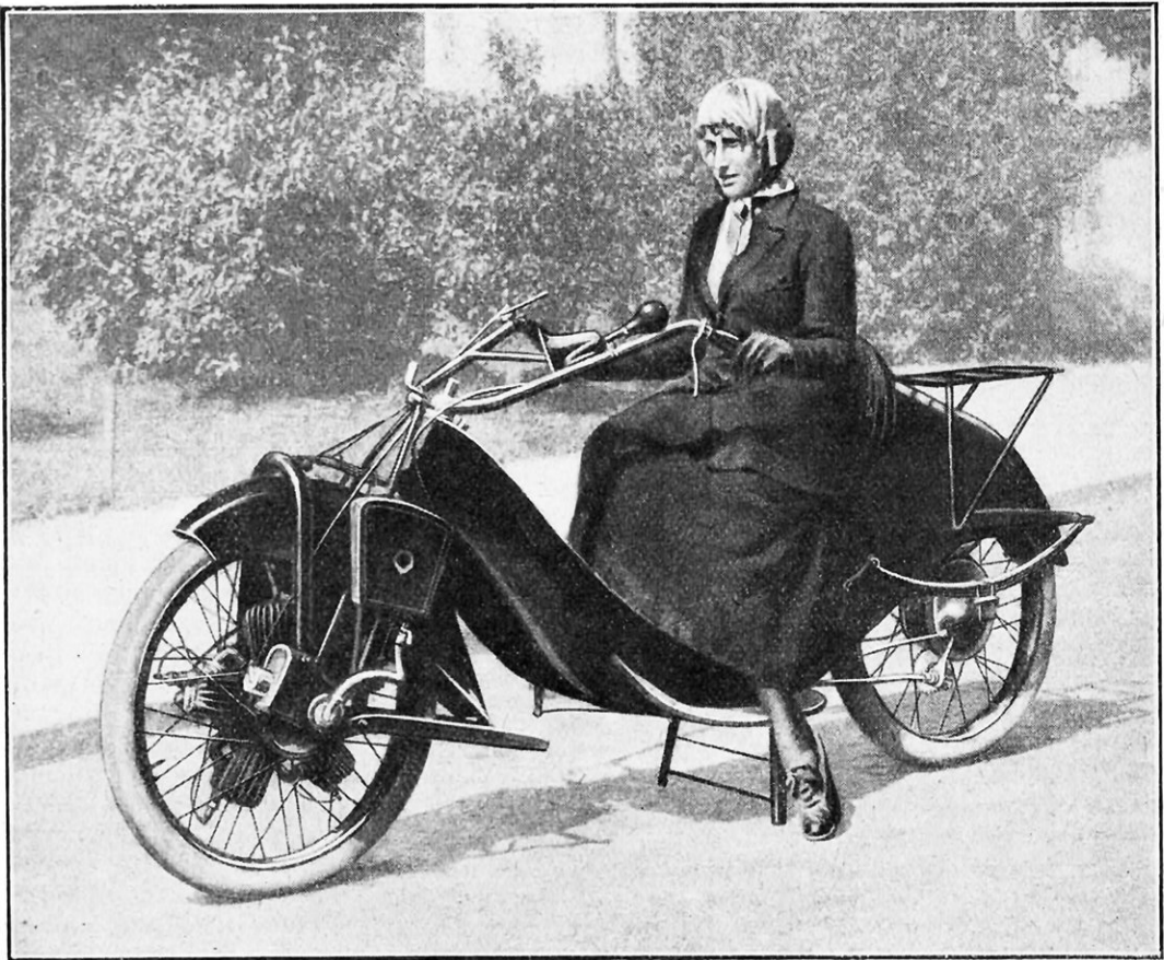
VUE D'ENSEMBLE DU MOTOCYCLE « MEGOLA », MUNI D'UNE NOUVELLE ROUE MOTRICE ET DIRECTRICE A L'AVANT ET POURVU D'UNE CARROSSERIE ÉLÉGANTE ET PRATIQUE
