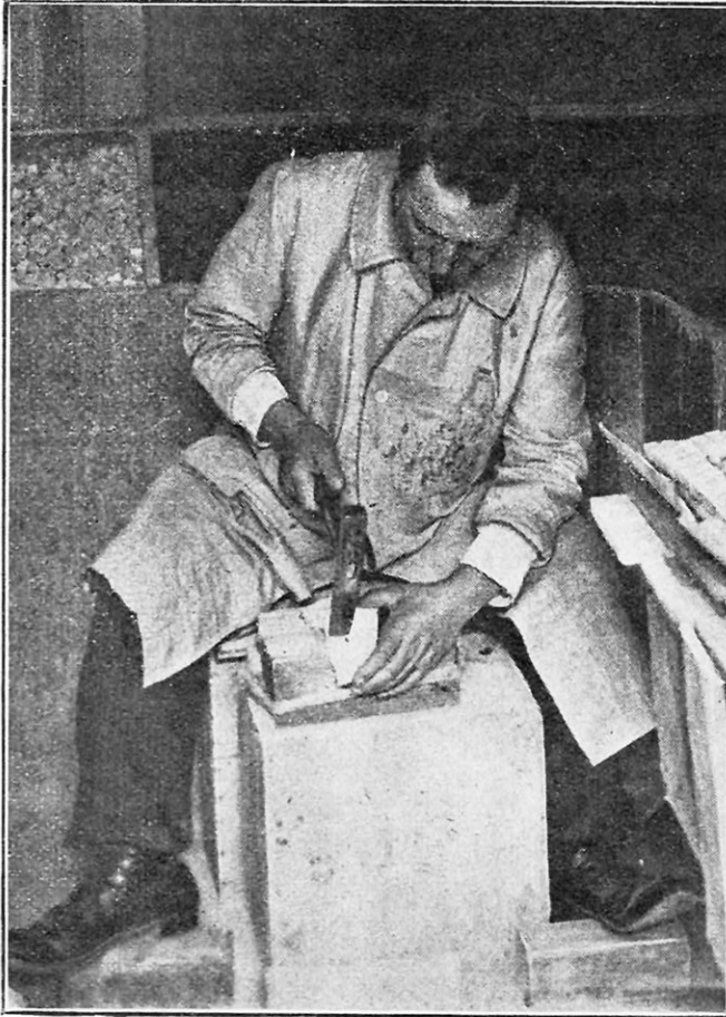
LE CONCASSAGE DES PLAQUES DE MARBRE EN PETITS CUBES A L'AIDE DE LA « MARTELINÉ »
