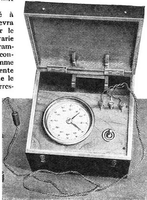
VUE DE FACE DE LA BOÎTE CONTENANT LE DISPOSITIF ENREGISTREUR DU NOMBRE DE GOUTTES TOMBÉES
