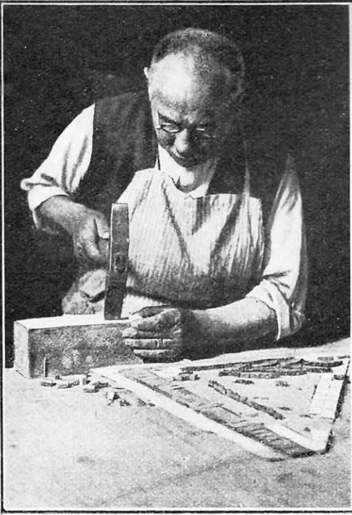
LES CUBES SONT RETAILLÉS AFIN DE LEUR DONNER UNE FORME LEUR PERMETTANT DE S'ADAPTER AUX LIGNES DU DESSIN
