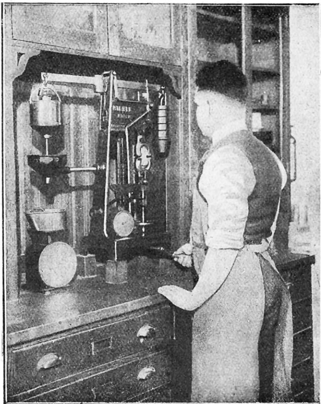
ICI, L'ON MESURE EXACTEMENT LA CAPACITÉ DE LIAISON DU CIMENT AU MOYEN D'ÉPROUVETTES
