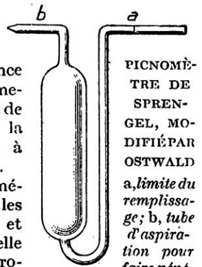
PICNOMÈTRE DE SPRENGEL, MODIFIÉ PAR OSTWALD a, limite du remplissage ; b, tube d'aspiration pour faire pénétrer dans le flacon le liquide dont on recherche la densité.
