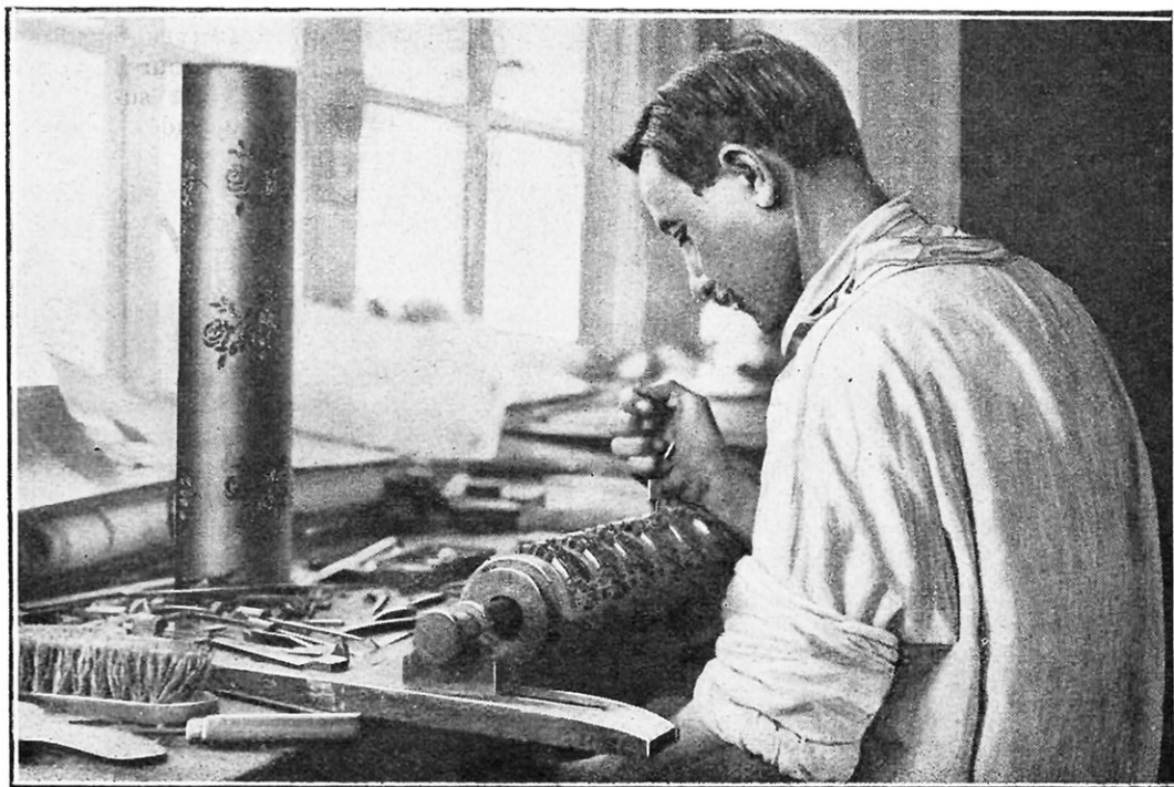
ON VOIT ICI UN OUVRIER OCCUPÉ À GARNIR UN ROULEAU D'IMPRESSION Il a enfoncé, de champ, sur le cylindre une lame de cuivre épousant tous les traits du dessin et, à l'aide de la pince ronde, il en redresse et en régularise très soigneusement les contours.
