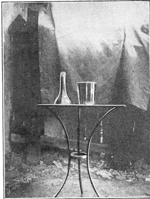
FIG. 7. — PAR LE PROCÉDÉ A L'HUILE, LA BOUTEILLE SE SECTIONNE ÉGALEMENT TRÈS BIEN
