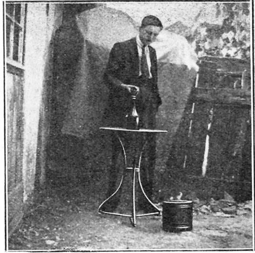
FIG. 5. — ON INTRODUIT DANS LA BOUTEILLE LA BARRE DE FER ROUGIE
