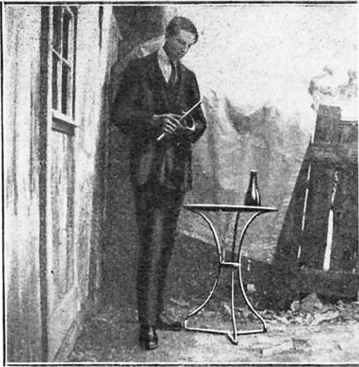
FIG. 3. — LE RODAGE A LA LIME DE LA SECTION DE BOUTEILLE COUPÉE.
