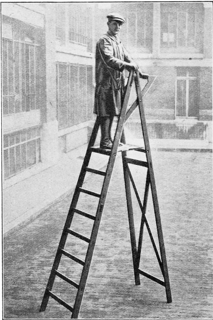
L'OUVRIER EST JUCHÉ SUR UNE PLATE-FORME HORIZONTALE
