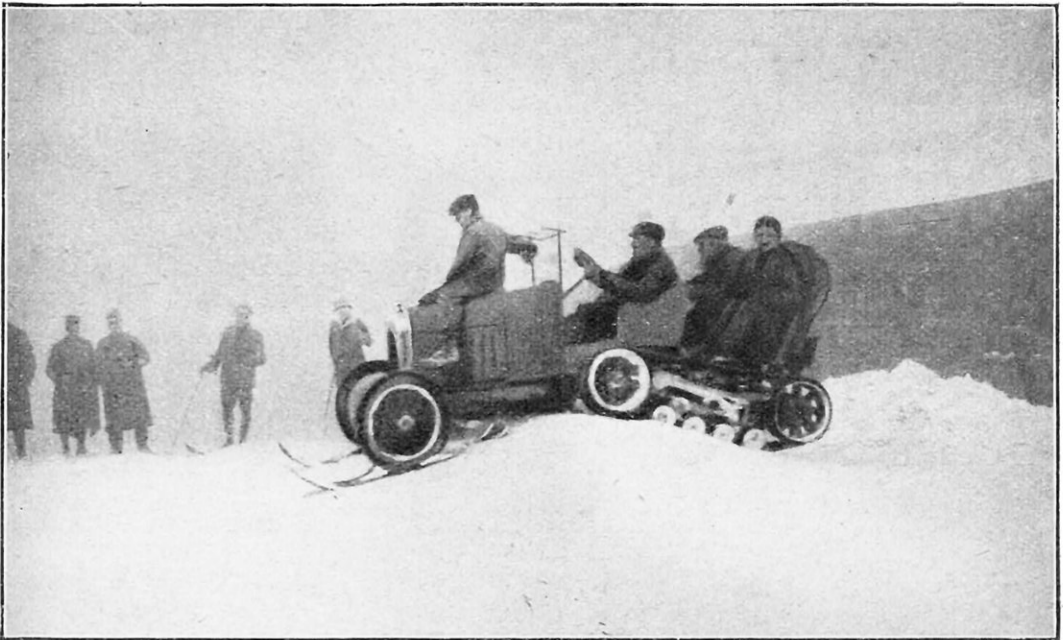
LA VOITURE, MUNIE DE LA CHENILLE SOUPLE, FRANCHIT UN MONTICULE DE NEIGE
