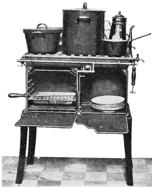
GRAND MODÈLE DU FOURNEAU A RÉCUPÉRATION D'AIR CHAUD FONCTIONNANT AU GAZ L'appareil est muni d'un bain-marie dont l'eau, ainsi d'ailleurs que le chauffe-plat et tous les récipients posés sur le dessus du fourneau, est chauffée par un brûleur unique. Ce dernier consomme moins de gaz qu'un seul des brûleurs multiples de l'appareil du type ordinaire.
