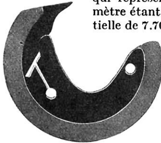
FRAGMENT PRÉLEVÉ A LA PÉRIPHÉRIE D'UNE SCIE CIRCULAIRE A DENTS RAPPORTÉES DU SYSTÈME ATRINS
