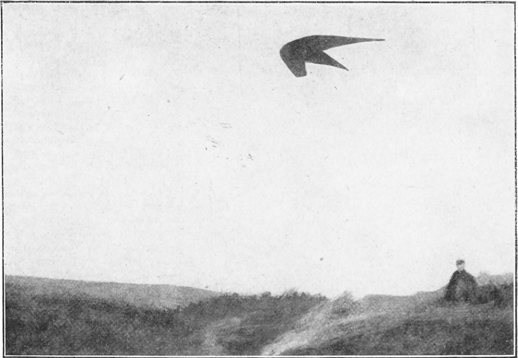
LE PLANEUR WEISS, SANS MOTEUR, S'ÉLEVANT CONTRE LE VENT
