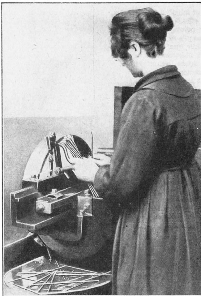
LA MACHINE A FILETER LES TÊTES DE RAYONS Le rayon est engagé perpendiculairement entre les deux plateaux de l'outil dont l'un est fixe et l'autre animé d'un mouvement constant de va-et-vient. Ce plateau entraîne le rayon devant un peigne qui comprime le métal et fait le pas de vis.
