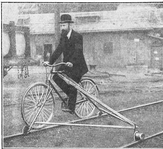
M. MARTIN, SUR LA BICYCLETTE QU'IL A ADAPTÉE AUX DÉPLACEMENTS SUR RAILS
