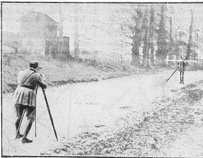
OFFICIER TOPOGRAPHE OPÉRANT AU TACHÉOMÈTRE L'instrument, monté sur trépied, est placé en un point connu ; l'opérateur vise la mire que tient au loin son aide.
