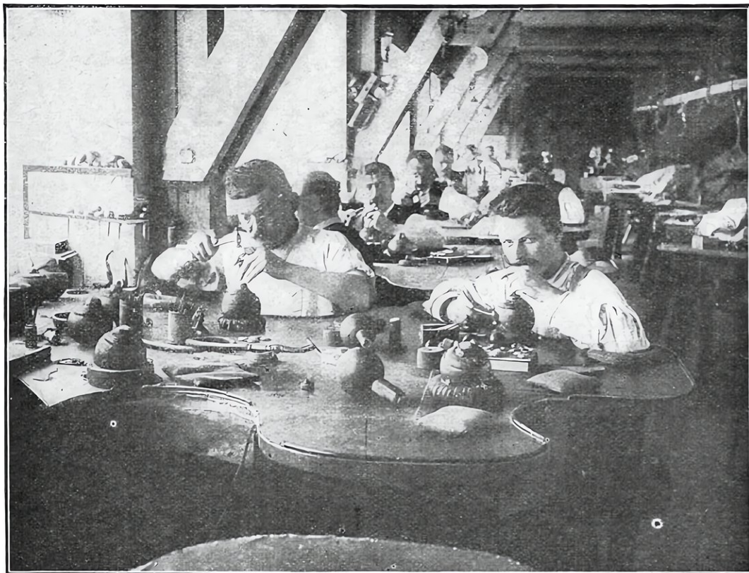
CISELURE DES BOÎTES DE MONTRES, MONTÉES SUR UNE SORTE DE BLOC DE CIMENT
