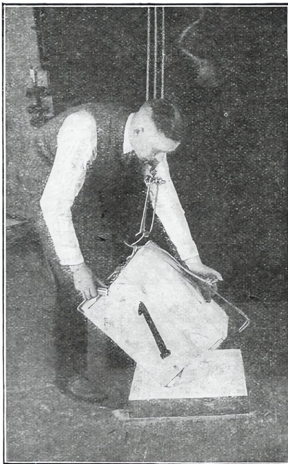
ACCROCHAGE D'UNE CAISSE D'EMBALLAGE POUR UN ESSAI DE CHUTE
