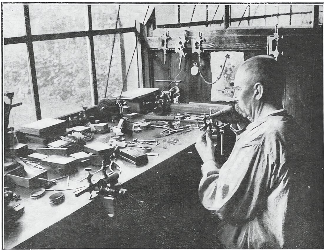
LE « PIVOTAGE » DES ÉCHAPPEMENTS EST UN TRAVAIL TRÈS DÉLICAT
