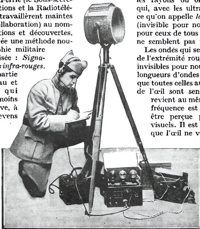
LA RÉCEPTION AU SON D'UN MESSAGE INFRA-ROUGE Les signaux, codifiés au Morse, sont reçus par l'opérateur absolument comme s'il s'agissait de messages de T. S. F.
