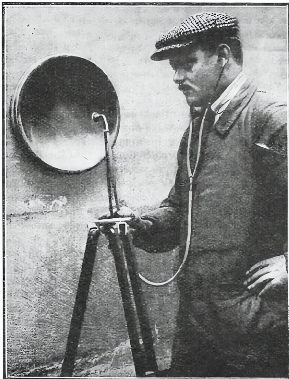
LA CAPSULE A NOIR DE FUMÉE PERMET LA RÉCEPTION DIRECTE PAR TUBE ACOUSTIQUE
