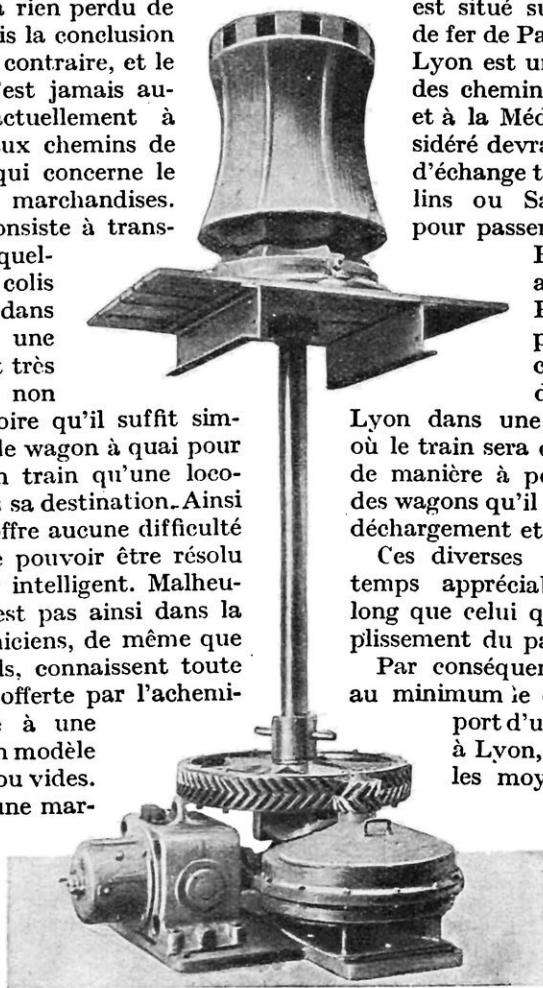
CABESTAN A MÉCANISME ÉLECTRIQUE SOUTERRAIN POUR HALAGE DE PÉNICHES DANS UNE GARE D'EAU SITUÉE LE LONG D'UN CANAL
