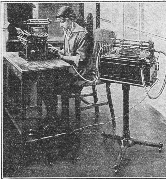
AU MOYEN DE TUBES ACOUSTIQUES, LA DACTYLOGRAPHE PREND LA DICTÉE ENREGISTRÉE PAR LE DISQUE
