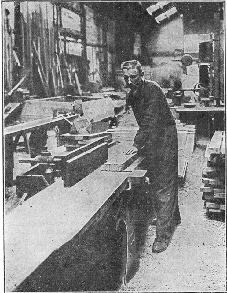
FIG. 4. — DÉGAUCHISSEUSE, POUR DÉGAUCHIR OU DRESSER LES SURFACES DES MERRAINS ET FAIRE MÉCANIQUEMENT LES JOINTS DES DOUVES ET DES FONDS
