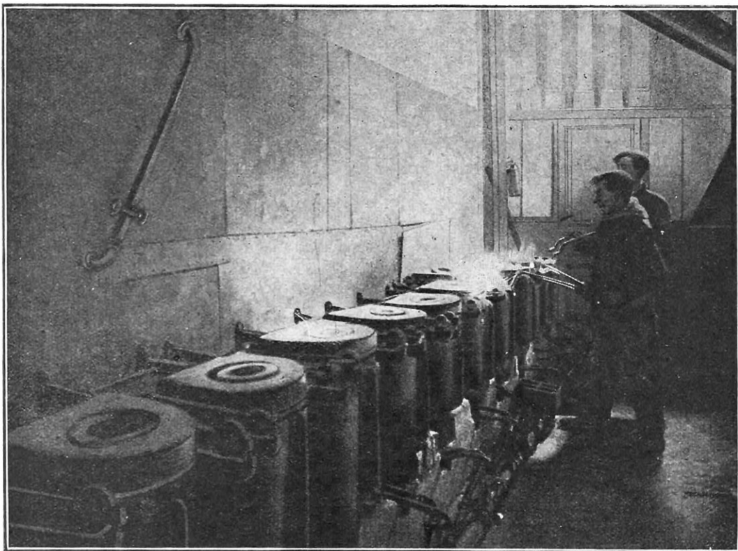
BATTERIE DE FOURS A GAZ SERVANT A OBTENIR LA TEMPÉRATURE DE 1.100 DEGRÉS NÉCESSAIRE A LA FUSION DE L'ALLIAGE DE FER ET DE CÉRIUM
