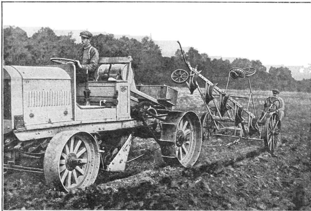
ARRIVÉE DE LA CHARRUE AU CONTACT D'UN TRACTEUR-TREUIL
