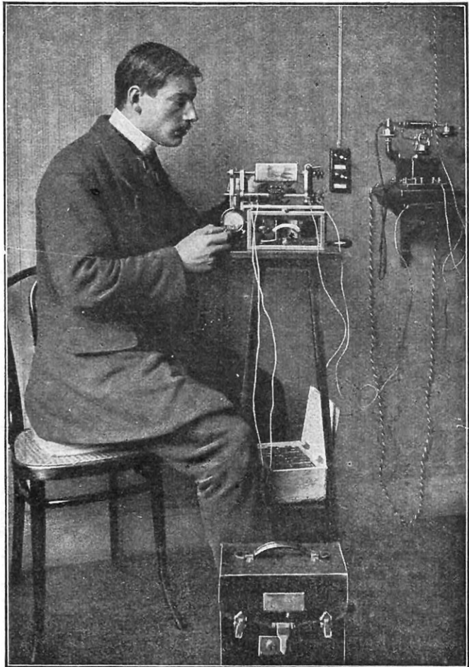
FIG. 13. — RÉPORTER DE JOURNAL ILLUSTRÉ « TÉLÉPHONANT » UNE PHOTOGRAPHIE DANS UNE CABINE PUBLIQUE A L'AIDE DE L'APPAREIL PORTATIF BELIN
