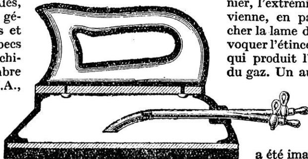
FER A REPASSER CHAUFFÉ INTÉRIEUREMENT PAR L'ACÉTYLÈNE
