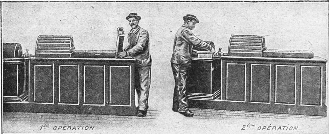
ont été montées sur les paliers, la boule du condenseur se trouvant au-dessus du bac à eau et recouverte de son couvercle, il suffit, comme nous l'avons dit, de faire tourner l'appareil pour qu'au bout de quelques minutes le réfrigérant tournant dans l'air se recouvre de givre, preuve évidente de la production immédiate du froid. Il faut avoir soin, bien entendu, de disposer une circulation d'eau
