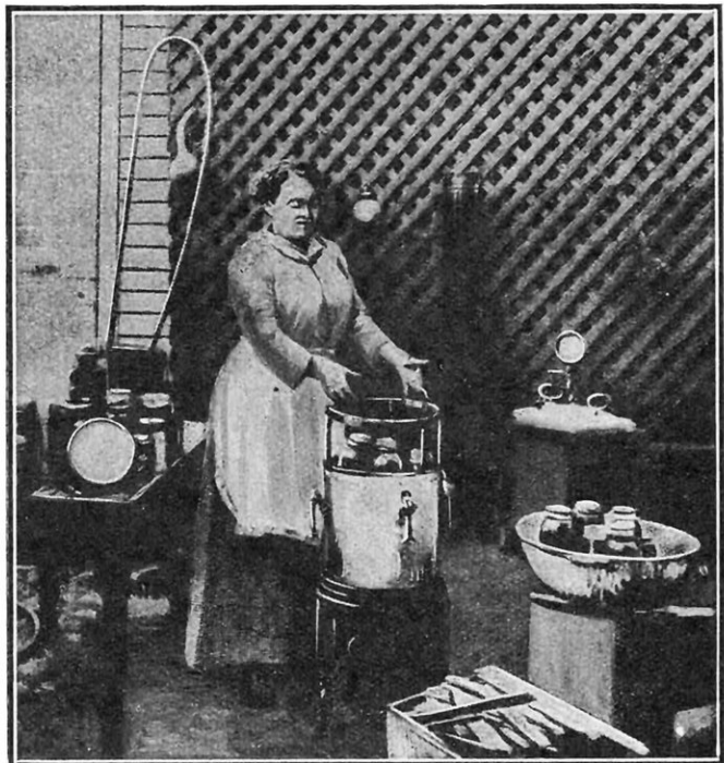
BOITES DE CONSERVES PLACÉES DANS LE PANIER DE L'AUTOCLAVE POUR ÊTRE STÉRILISÉES
