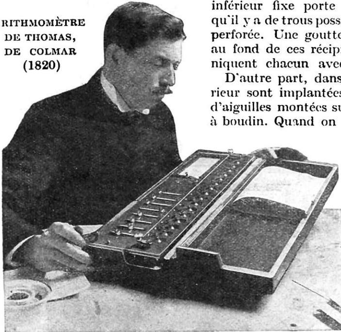
Un certain nombre d'établissements financiers emploient cet instrument, qui se compose d'une plaque métallique horizontale fixe sur laquelle on peut inscrire le multiplicande ou le diviseur, grâce à des boutons poussés dans des rainures.
