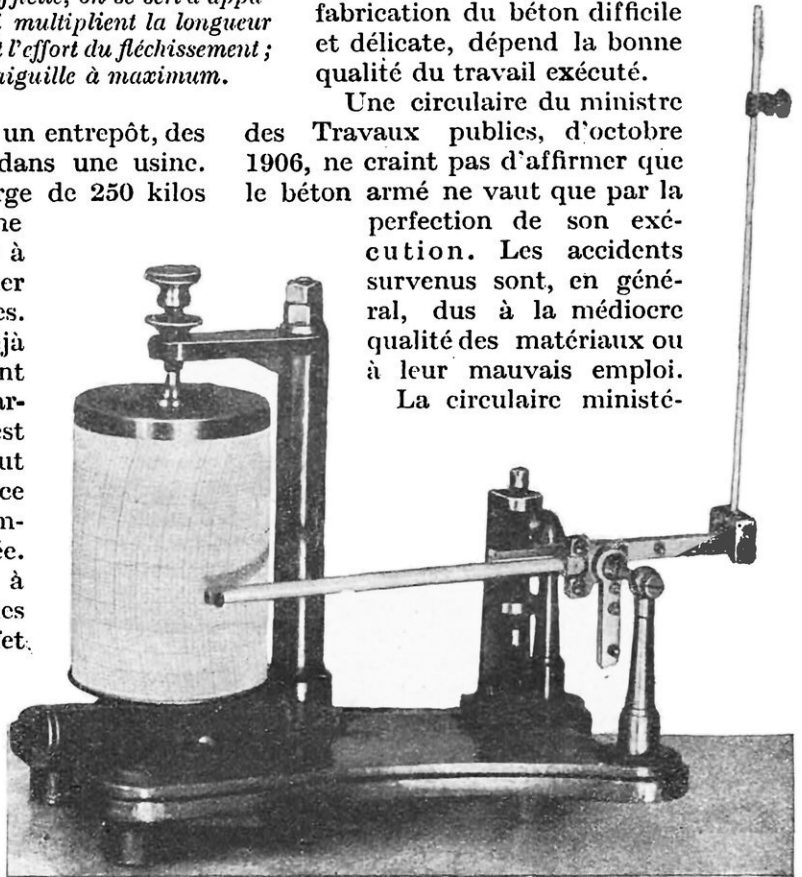
AMPLIFICATEUR DE VIBRATIONS ET DE FLEXIONS IMAGINÉ PAR M. RABUT, INGÉNIEUR EN CHEF DES PONTS ET CHAUSSÉES.
