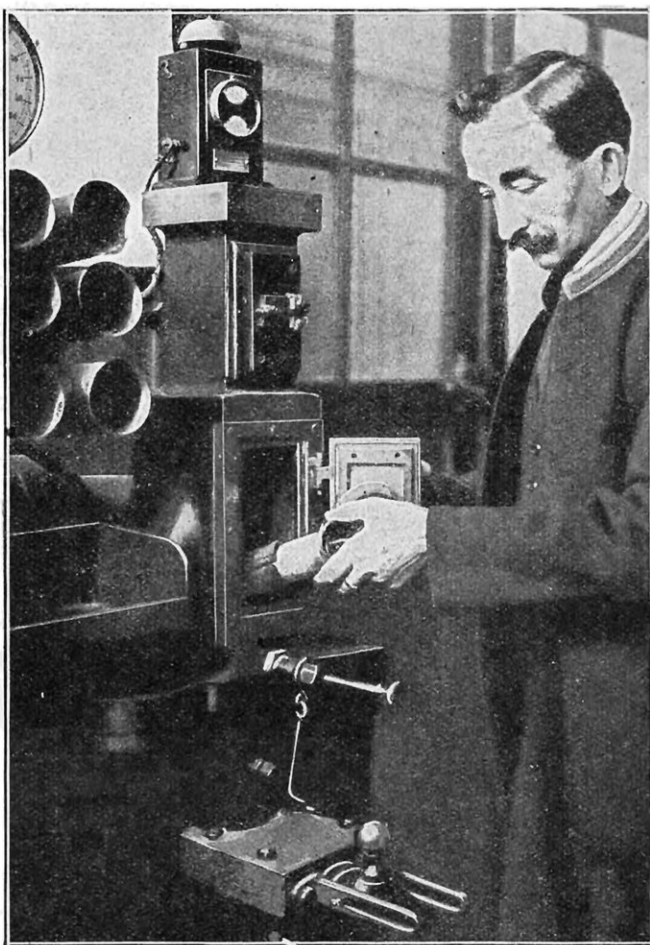
FIG. 24. — LE TUBISTE ENGAGE UN « PISTON » POUR LE FAIRE PARTIR PAR LA LIGNE
