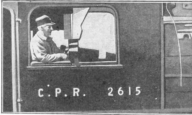
QUELLES QUE SOIENT LES CONDITIONS DE TEMPS, L'APPAREIL PERMET D'OBSERVER AISÉMENT LA ROUTE
