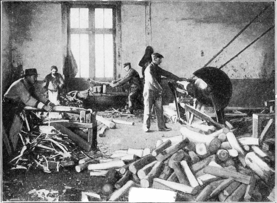
ÉCORÇAGE ET SCIAGE DU BOIS EN VUE DE SON TRAITEMENT POUR LA MISE EN PÂTE
