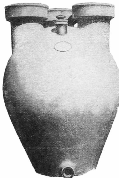
TOURIE DE NEUTRALISATION A TROIS TUBULURES
