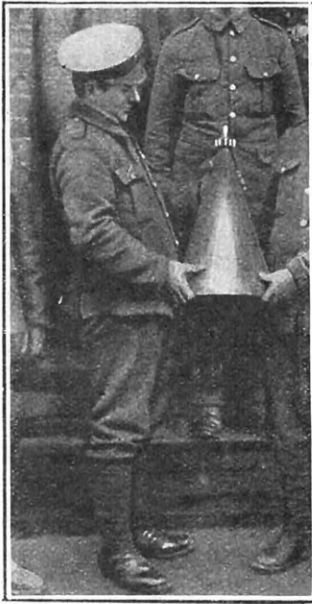
TORPILLE AÉRIENNE RAMASSÉE SUR LA CÔTE ANGLAISE, Elle diffère du type précédent en ce sens qu'elle est complètement conique.
