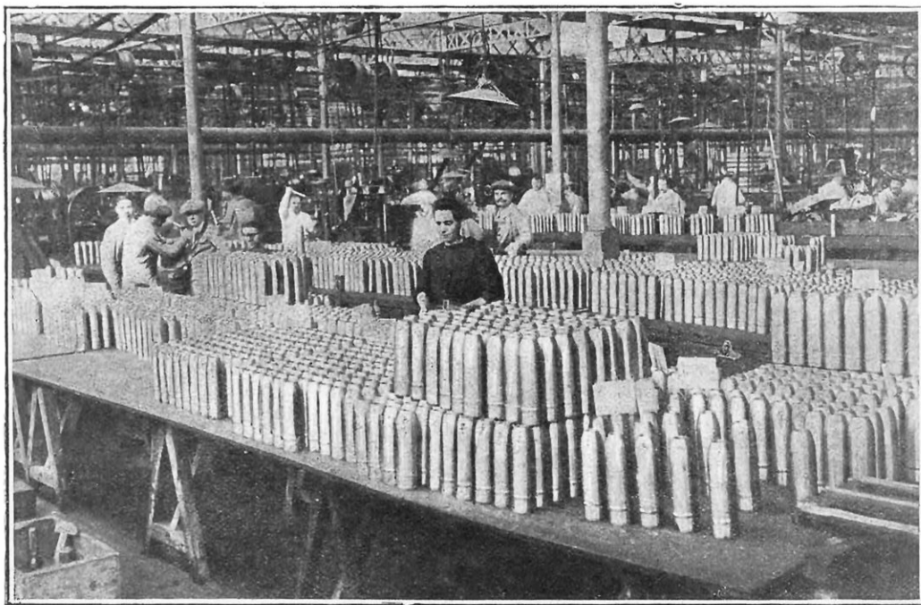
UNE FOIS TERMINÉS, LES CORPS D'OBUS SONT CONTROLÉS SOIGNEUSEMENT ET MESURÉS Ce travail est confié, en majeure partie, à des femmes munies d'appareils de contrôle d'une grande précision. Puis les agents réceptionnaires du ministère de la guerre examinent à leur tour les projectiles.
