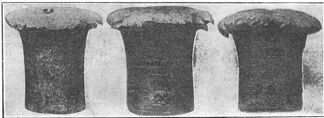
Explosion de 20 grammes de dynamite avec une amorce de 1 gr 30.
