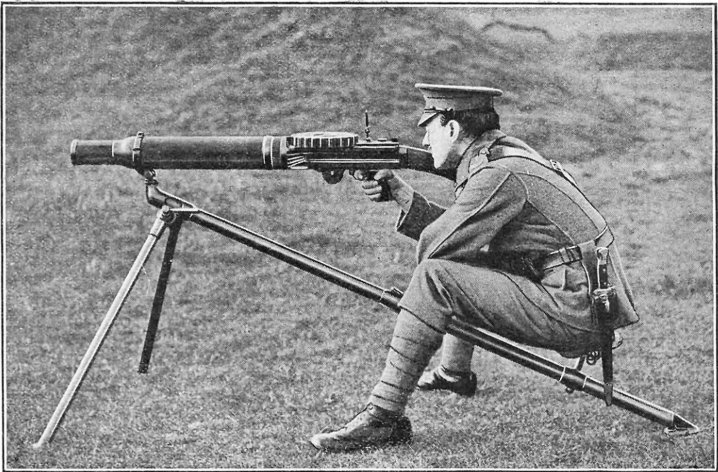
TIR AU FUSIL MITRAILLEUR EXÉCUTÉ A L'AIDE DU TRÉPIED DE CAMPAGNE Le tireur est assis sur une selle coulissant sur le tube postérieur du trépied; l'arme est fixée à l'extrémité de ce tube au moyen d'un collier mobile qui permet les variations de l'angle de pointage
