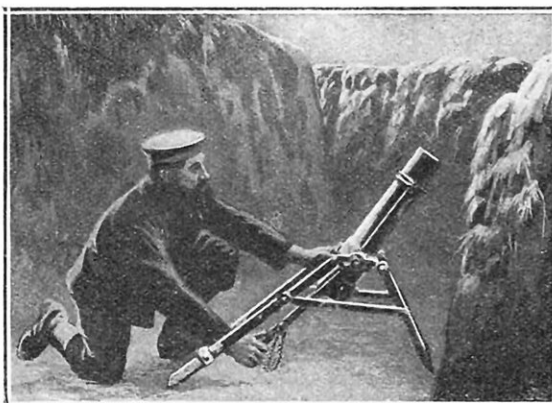
PETIT "MINENWERFER" ALLEMAND MONTÉ SUR UN TRÉPIED DE MITRAILLEUSE
