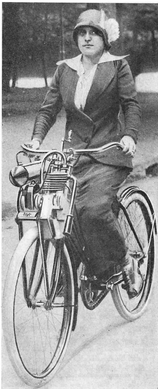
CETTE CYCLISTE N'A PAS BESOIN DE PÉDALER Le mototracteur adapté sur une bicyclette ordinaire la transforme en motocyclette tout en lui conservant ses qualités de légèreté et de souplesse.
