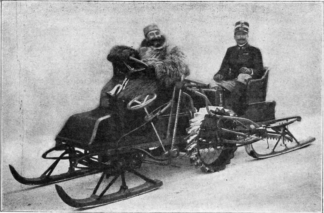
LE TRAGNEAU DU LIEUTENANT DE LA BESSE A BÉNÉFICIÉ DES PROGRÈS DE L'AUTOMOBILISME Le traîneau est une véritable automobile dont les roues ordinaires, trop lisses pour mordre les surfaces unies de neige ou de glace, ont été remplacées par des roues motrices à jantes cannelées.
