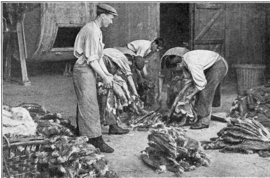
LE TRIAGE DES PEAUX DE LAPINS DANS UNE « MANUFACTURE » DE FOURRURES Il faut environ six semaines pour transformer une peau de lapin. Les dépouilles, fendues du côté du ventre, sont d'abord retournées et séchées, puis triées avec soin selon leur qualité.
